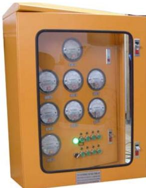
沃尔士公司为解决除尘器总管及各分箱体差压显示的需求，专门为客户研制成功的差压控制盘，其目的在于为客户真实的反应除尘器的运行工况，通过该控制箱可随时对除尘器及其各箱体的运行阻力情况、分风平衡情况、清灰效果、布袋寿命等关键参数进行监视。该系统采用沃尔士自行研发的反向测管清堵控制器，完全解决了由于测压导管堵塞而造成的显示误差和故障。
